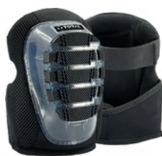
GENOLLERES ARTIFLEX 23046123 Carcassa TPR, tèxtil de teryleno, escuma EVA, elàstics de neoprè. Genolleres tipus 1 segons EN 14404-2:2024.
